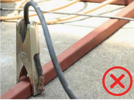
Şekil-3 Yanlış tatbik edilen topraklamaya örnekler
