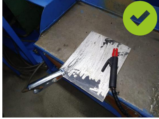
Şekil-2 Topraklama kaynak yapılan bölgeye yakın yapılmalıdır
